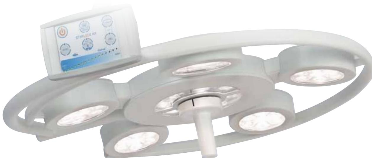
I 43 LED che compongono STARLED5 NX sono disposti circolarmente e suddivisi in 5 corpi faro (con 7 led cad.) e altri 8 led disposti a raggio intorno al manipolo.
