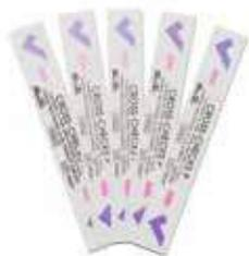
**Des indicateurs chimiques** sont utilisés pour chaque cycle et dans chaque emballage afin de valider la pénétration et d'assurer que la charge était en contact avec le peroxyde d'hydrogène vaporisé.
